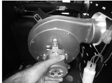
Figura 33 - a) Retirar os parafusos; b) Retirar extractor
