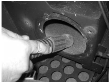
Figura 34 - Aspirar a zona de passagem do ar
